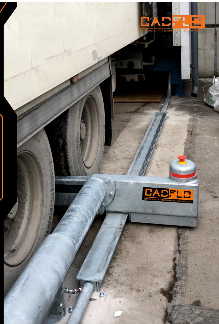
Прочная конструкция системы изготовлена из оцинкованной стали и дополнена колесной направляющей с противоположной от системы стороны. Это гарантирует точное позиционирование грузовика перед доком.
